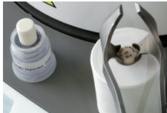
Beide kalten IPS e.max ZirPress Rohlinge mit der Rohlingsfarbe nach oben in die heisse Muffel geben.
