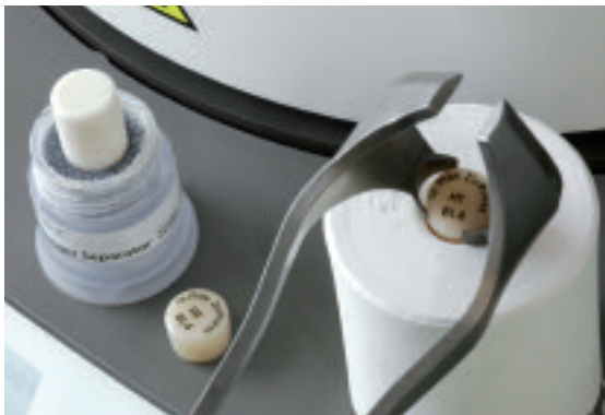
Beide kalten IPS e.max ZirPress Rohlinge mit der Rohlingsfarbe nach oben in die heisse Muffel geben.
