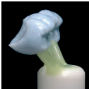
Anstiftung erfolgt auf der IPS e.max Muffelbasis immer in Fließrichtung und an der dicksten Stelle.
