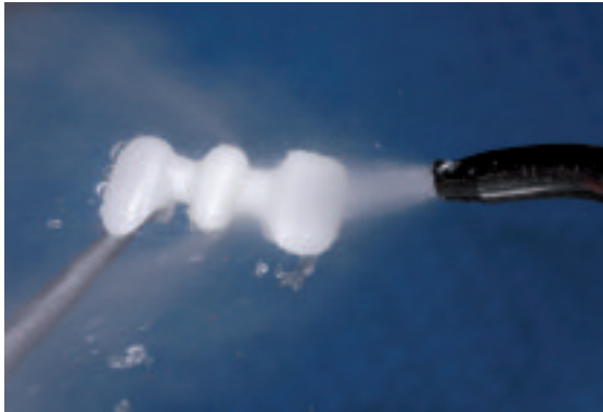
Vor dem ZirLiner-Auftrag Gerüst unter fließendem Wasser oder mit dem Dampfstrahler reinigen.
