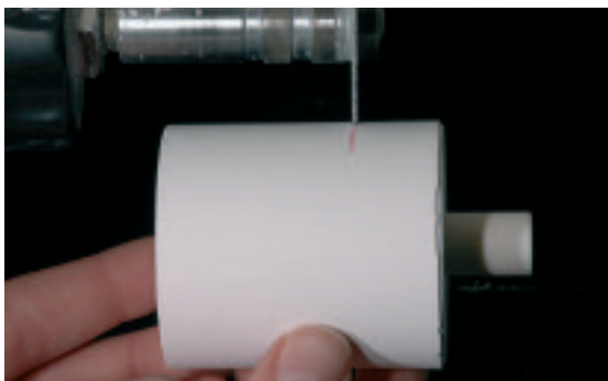
Muffel mit einer Trennscheibe separieren und an der Sollbruchstelle brechen.
