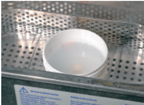
Entstandene Reaktionsschicht mit Invex entfernen und mit \text{Al}_2\text{O}_3 und 1–2 bar Druck sorgfältig reinigen.
