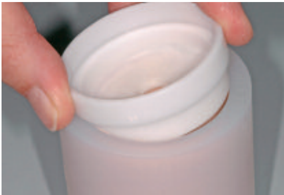
Muffel bis zur Markierung auffüllen und Muffellehre in einer Kippbewegung aufstecken.
