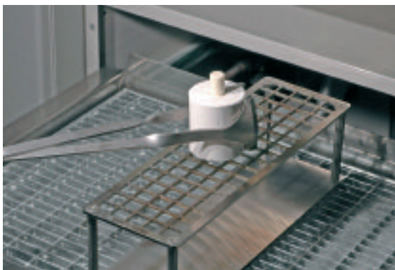
Nach Beendigung des Pressprogramms die heisse Muffel mit der Muffelzange auf das Abkühlgitter stellen und auf Raumtemperatur abkühlen lassen.
