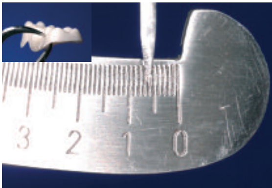
Schichtstärke mit Taster messen.
