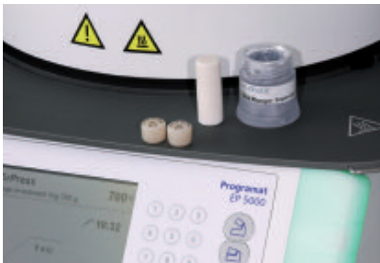
Kalten isolierten IPS e.max Alox-Kolben und kalte IPS e.max ZirPress Rohlinge in der gewünschten Farbe bereitstellen.
