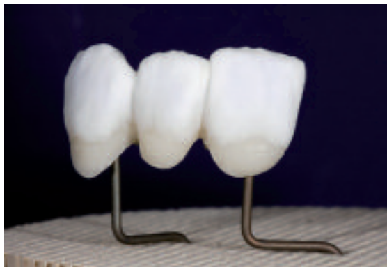
Restauration auf dem Brennträger positionieren und mit den Brennparametern für den Incisalbrand brennen
