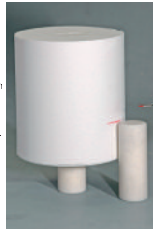
Länge des Alox-Kolbens markieren
