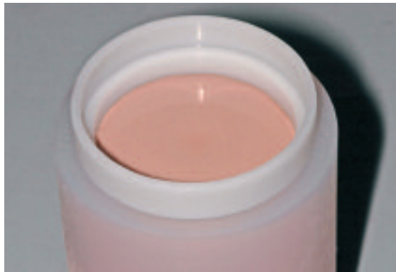
Muffel bis zur Markierung auffüllen und Muffellehre in einer Kippbewegung aufstecken.
