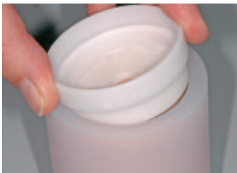
Muffel bis zur Markierung auffüllen und Muffellehre in einer Kippbewegung aufstecken.
