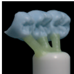
Anstiftung erfolgt auf der IPS e.max Muffelbasis immer in Fließrichtung und an der dicksten Stelle.
