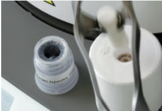
Anschließend den mit Pulver benetzten IPS e.max Alox-Kolben in die heisse Muffel geben.
