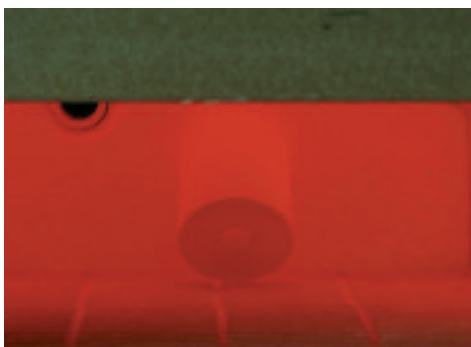
Muffel rückwändig im Ofen mit Öffnung nach unten platzieren.
