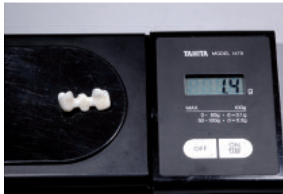
ZirCAD-Gerüst abwiegen und Gewicht notieren.
