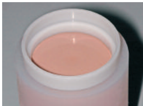
Muffel bis zur Markierung auffüllen und Muffellehre in einer Kippbewegung aufstecken.
