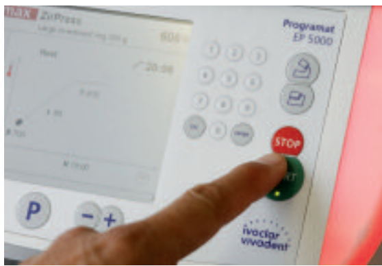
Der Start des Programmes ist durch Änderung der Farbe am OSD-Display sichtbar (Programat EP 5000).
